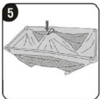
Drücken Sie die Mittelstütze nach unten, bis sie fest einrastet.
