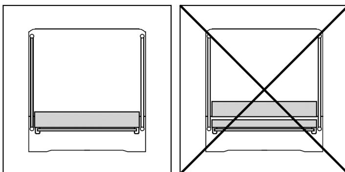
Das Kinderbett Trevel ist erst einsatzbereit, wenn die Verriegelungsmechanismen eingerastet sind. Überprüfen Sie vor der Verwendung sorgfältig, ob sie vollständig eingerastet sind.
